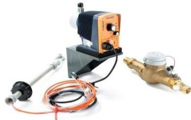
**Kompaktdosieranlage bestehend aus:** Pumpe mit 3-LED-Anzeige, externer Kontaktwasserzähler, Sauglanze mit zweistufigem Niveauschalter, PP-Dosierventil, 1 m PE-Dosierleitung, Wassermesserverschraubung (Holländer), Dichtungen, 2 m Externkabel, Hublängeneinstellung 50 - 100 %, Wandhalterung für Dosierpumpe
